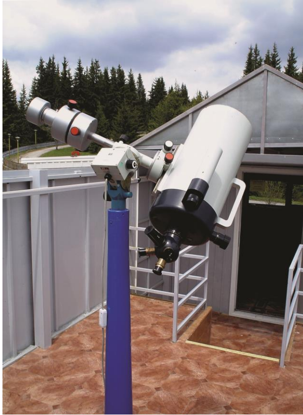
Фиг. 23. Телескоп Carl Zeiss Jena Meniscas 180/1800, f/10 , система Максудов-Касегрен. Същият бе използван в Посетителския център на НАО Рожен. Снимка: авторът, 2008 г.
